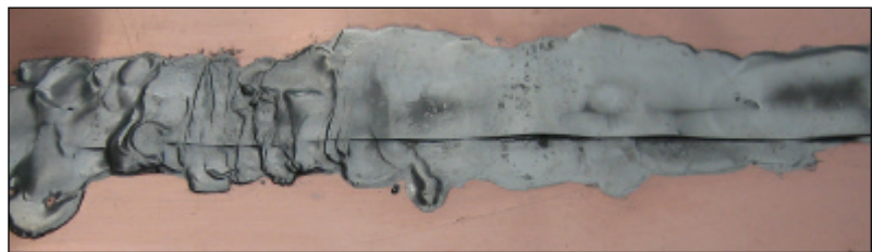
Abb. 3: Schlechte Werkstattnaht. Links im Bild wurde zu kalt und rechts zu heiss gelötet, zu erkennen an der Verformung der Nahtverbindung bzw. an der Bildung von «Körnern» im Zinnbad.
