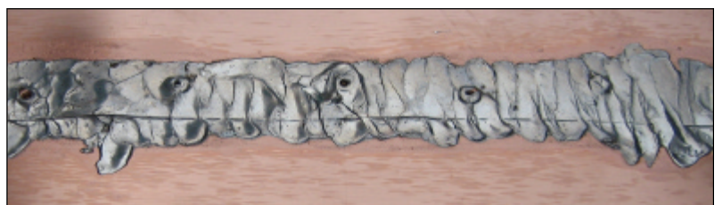
Abb. 5: Schlechte Baunaht. Zu geringe Wärmeübertragung, kein Durchfluss, die Nietenköpfe sind nicht dicht.
