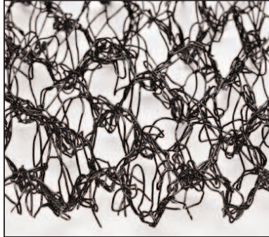
Abb. 4: Dreidimensionale offene Polyamidstrukturmatte.
